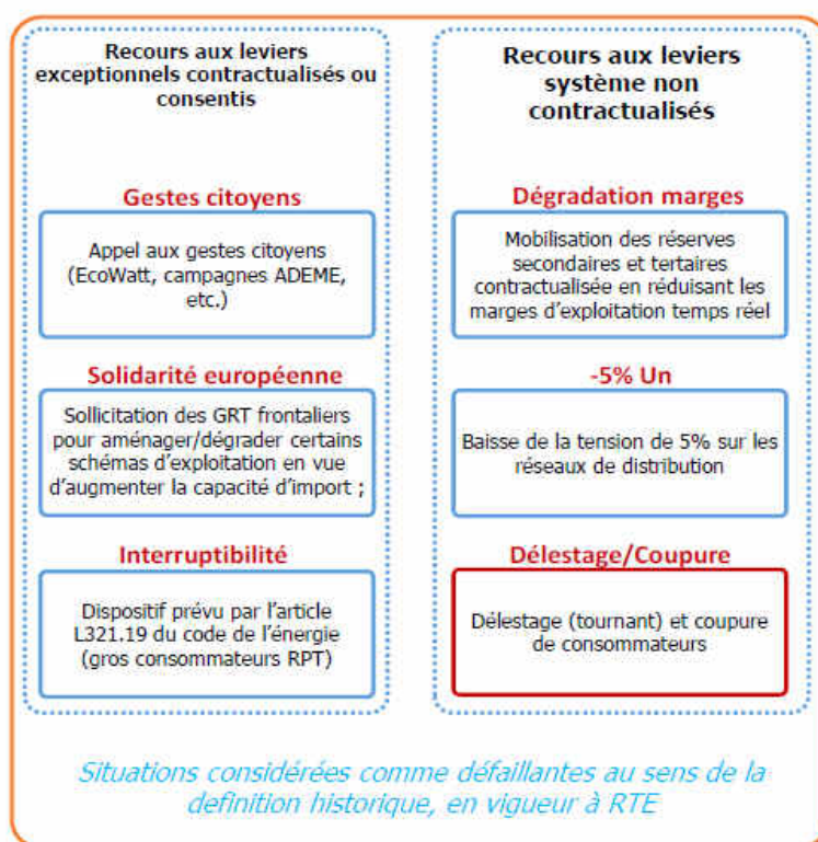
Figure 12 : Situations de défaillance - Source : RTE, 2018
